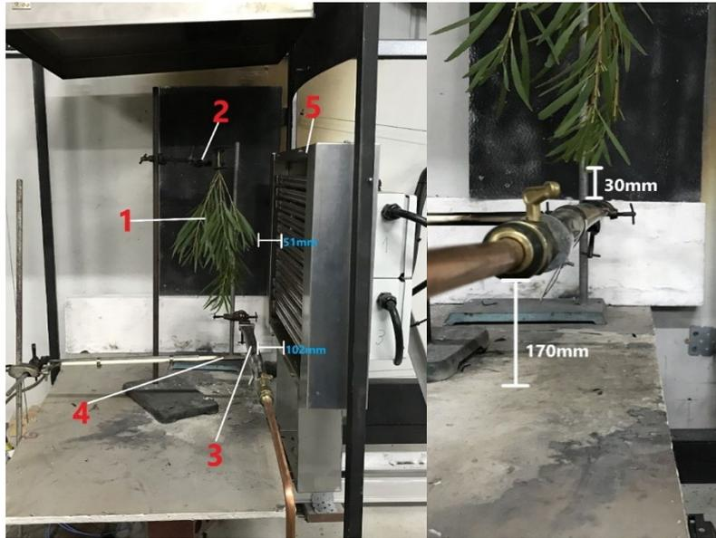
FIG. 15. EXPERIMENTAL DESIGN: a) HORIZONTAL ARRANGEMENT: 1) SAMPLE, 2) CLAMP, 3) PILOT IGNITER, 4) SPARK IGNITER, 5) RADIATIVE PANEL; b) VERTICAL ARRANGEMENT.
